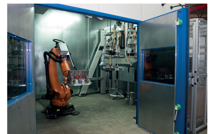
Schlüsselfertige GTV Beschichtungsanlage für die Reparaturbeschichtung von Austauschmotoren.
